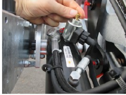
Funzionamento di emergenza manuale su tutte le elettrovalvole.
