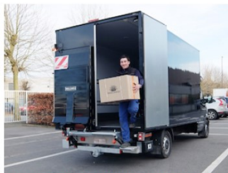
Libero accesso al vano di carico: disponibile con la Piattaforma a metà larghezza, o con la piattaforma verticale pieghevole
